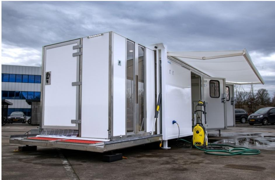
Die DEKON-Einheiten haben einen geringen Flächenbedarf durch ausziehbare Dusch-/Spülkabine für die Einsatzkräfte und deren Ausrüstung (Bild: Gemco).
