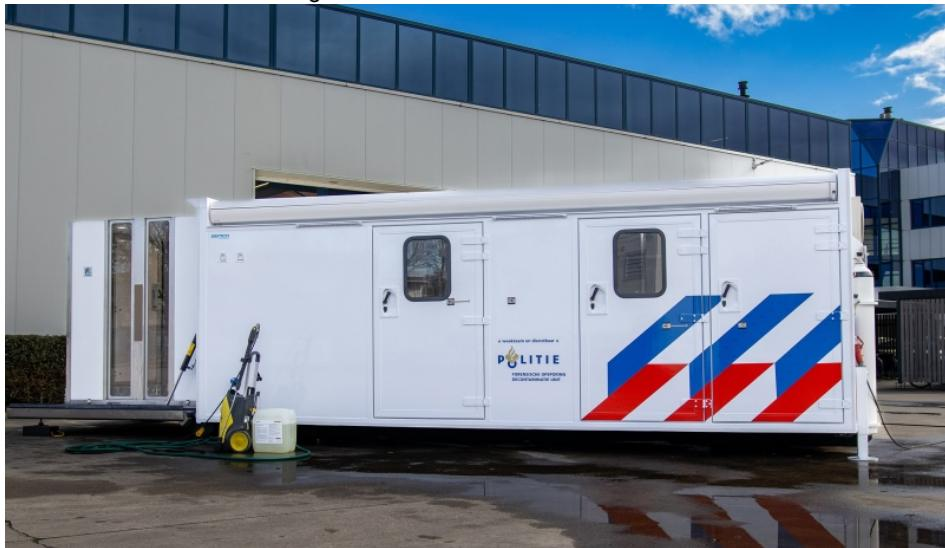
Bei den neuen DEKON-Einheiten handelt es sich um Rapid Response Unit, die schnell und einfach an den Einsatzort gebracht werden können und dort autark sind. Es wird lediglich ein Wasseranschluss benötigt (Bild: Gemco).
