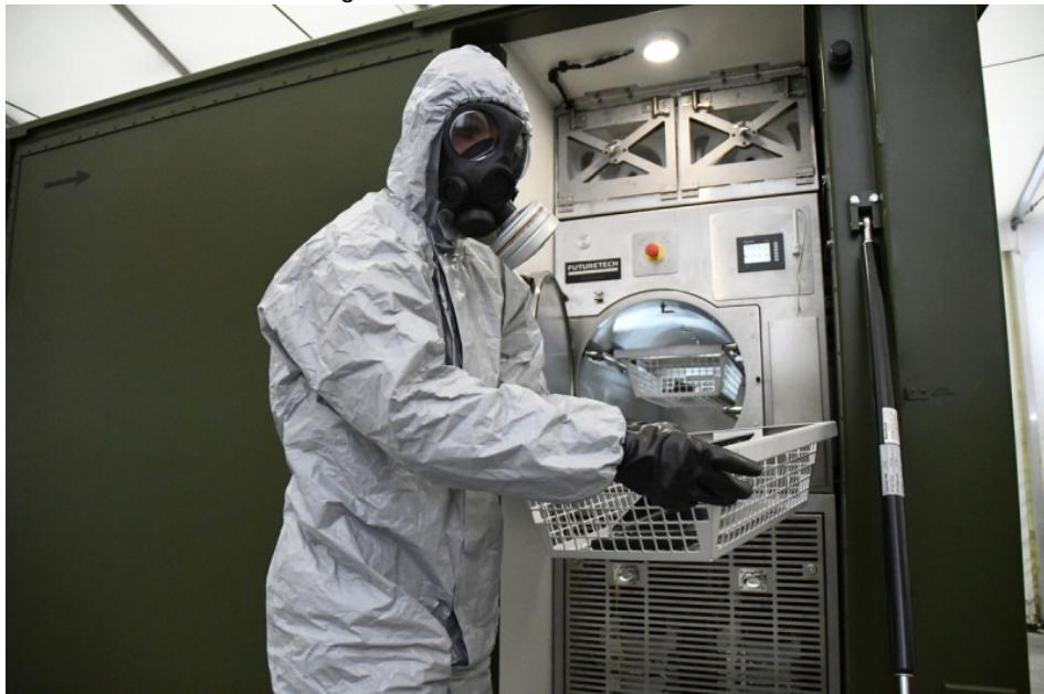
Mit der Vakuumkammer »VDM 265« können empfindliche elektronische Geräte wirksam und materialschonend chemisch und biologisch dekontaminiert werden. Die einzigartige Technologie beruht auf einer optimalen Abstimmung von Temperatur und Vakuumzyklen (Bild: Kärcher Futuretech).
