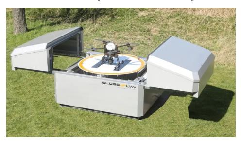
Der Drohnenport steht vor Ort im Einsatzgebiet, bspw. bei der Feuerwehrleitstelle. Die Drohne ist in dem Port sicher verwahrt und innerhalb von 30 Sekunden flugbereit (Bild: Bosch).
