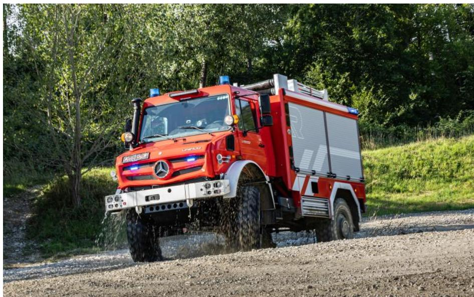
Der hochgeländegängige Unimog als Tanklöschfahrzeug ist für Einsätze in besonders schwerem Gelände, wie beispielsweise Wald- und Vegetationsbrände oder Hochwasser- und Hilfeleistungseinsätze, konzipiert (Bild: Daimler Truck).
