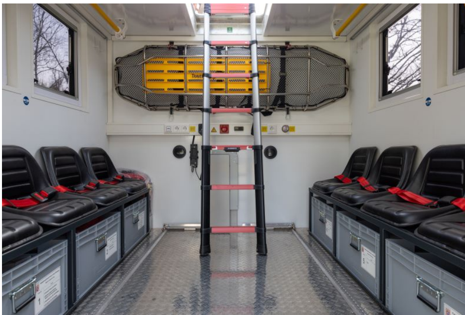
Rettung aus 1,2 m Hochwasser: Unimog mit Evakuierungsmodul samt 8 Gurtplätzen, Schleifkorbtrage, Dachluke, Leiter (Bild: Daimler Truck).
