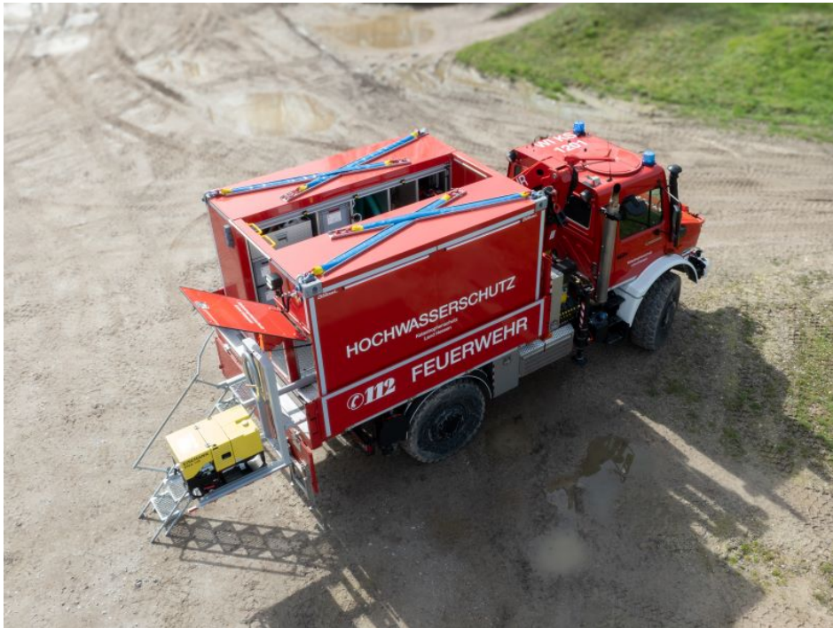
Das Wechselmodul Hochwasserschutz ist der rollende Werkzeugkoffer mit Normbeladung eines GW-L HW (Bild: Daimler Truck).
