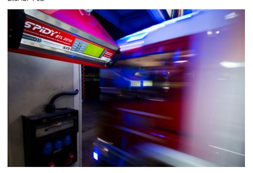
»BTL Powersingle 16A /25A« (links) für ein Fahrzeug und rechts ein »BTL 2016« für bis zu vier Fahrzeuge (Bild: IEP Pölz).
