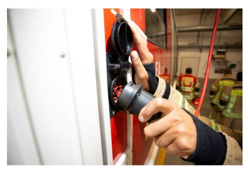
Das IEP »Multifunktionssystem« (Stecker und Dose) bündelt Strom- und Luftversorgung sowie eine Datenleitung. Dies sorgt für einen stets sicheren Start der Einsatzfahrzeuge mit aufgeladenen Bordbatterien und anderen Verbrauchern (Bild: IEP Pölz).
