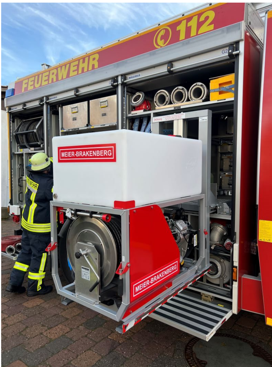
Verlastung auf TS-Schienen im Feuerwehrfahrzeug (Bild: Meier-Brakenberg).
