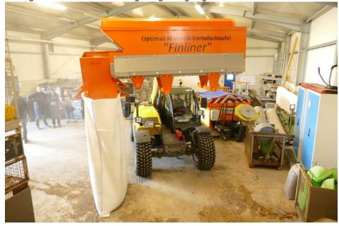
Über das Förderband der Materialschaufel wird das Füllgut in den Big Bag gebracht (Bild: Optimas).
