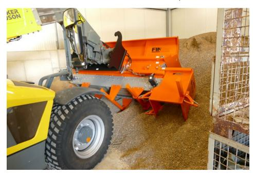
Die Optimas »Finliner«-Materialverteilschaufel wird an einen Radlader angebaut. Damit kann das Material aufgenommen werden (Bild: Optimas).
