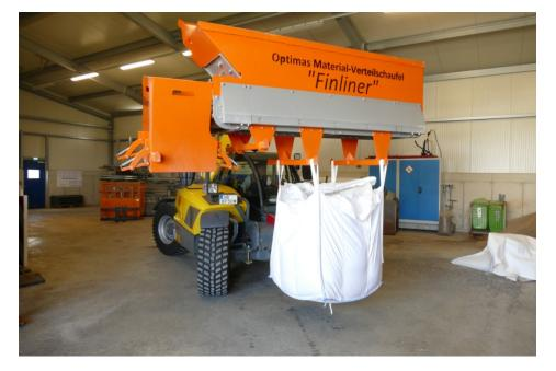
Der Big-Bag wird an die Haltehaken gehängt und zum Einsatzort gefahren (Bild: Optimas).
