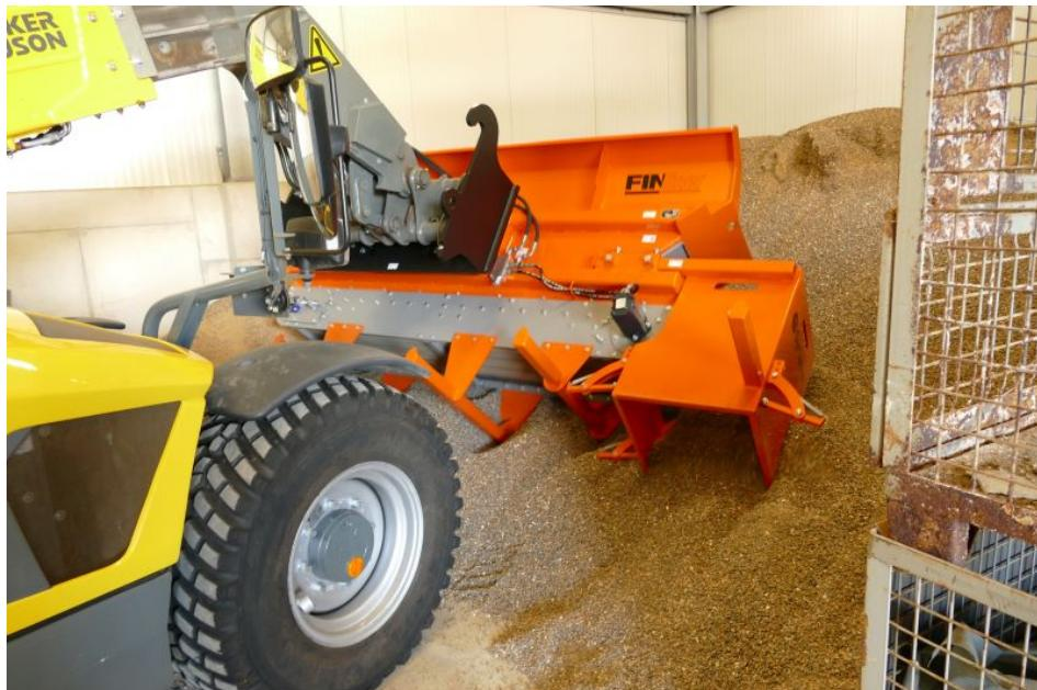
Die Optimas »Finliner«-Materialverteilschaufel wird an einen Radlader angebaut. Damit kann das Material aufgenommen werden (Bild: Optimas).
