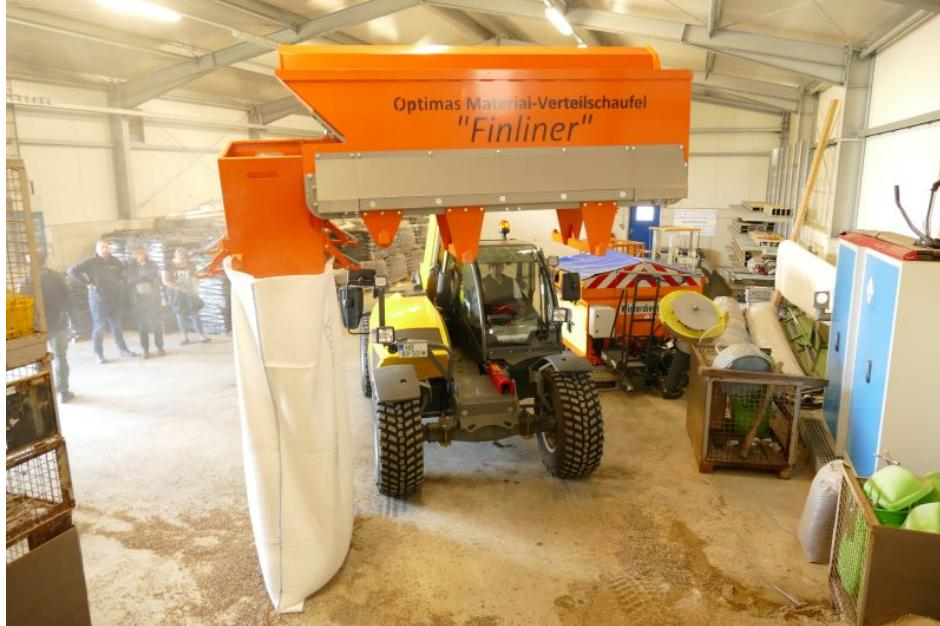
Über das Förderband der Materialschaufel wird das Füllgut in den Big Bag gebracht
