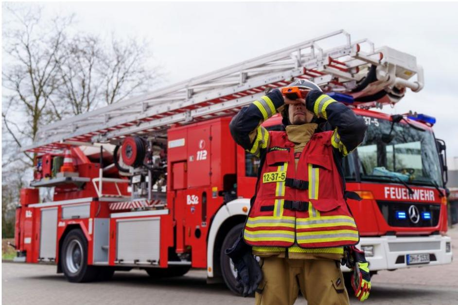
Anvisierung eines Anleiterpunktes zur Prüfung der Positionierung der Drehleiter mit dem »ALF« (Bild: FW Iserlohn / prosimpl).
