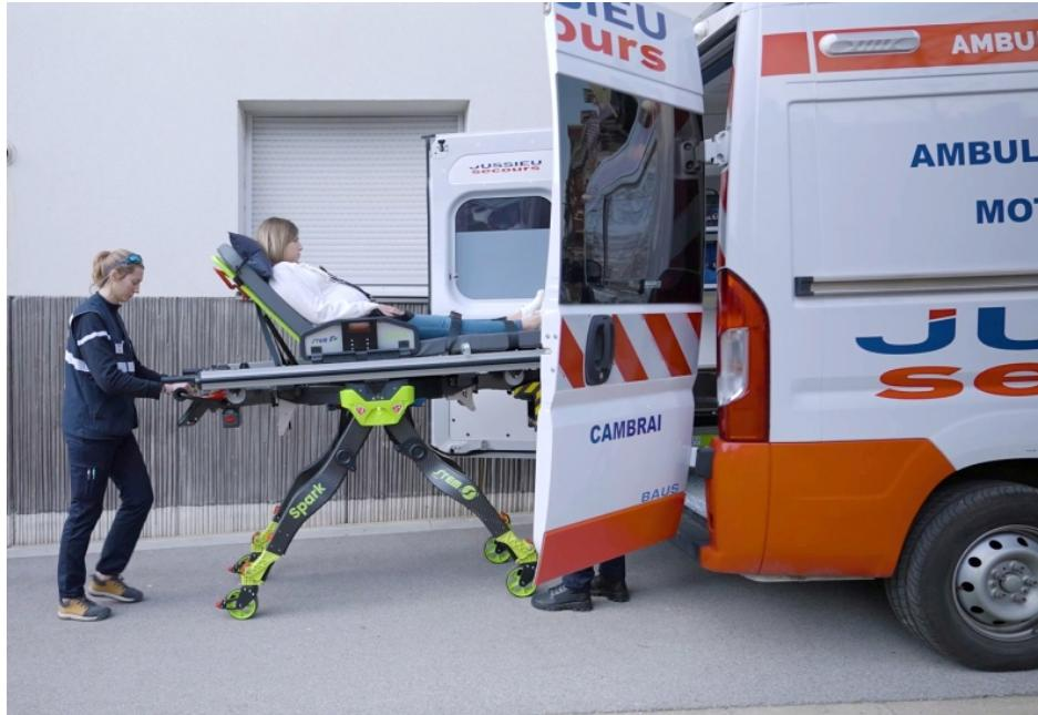
Die Drehachse der »SPARK«-Räder ist vertikal und steht immer senkrecht zum Boden. Dadurch lässt sich die Fahrtrage in jeder Neigung und jeder Höhe leicht manövrieren (Bild: STEM).
