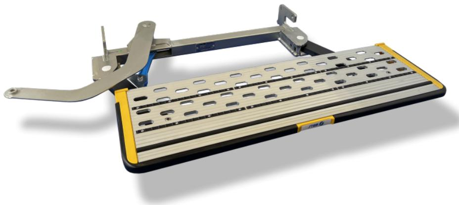
Einfahrbare Trittstufen für jedes Fahrzeug: elektrisch oder mechanisch, automatisch
