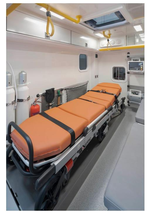
Für den Aufbau wurde ausschließlich hitzebeständiges anorganisches Material verbaut und die integrierte Hochleistungsklimatechnik im Thermo-Kofferaufbau schützt Besatzung und Patienten vor großer Hitze (Bild: WAS).
