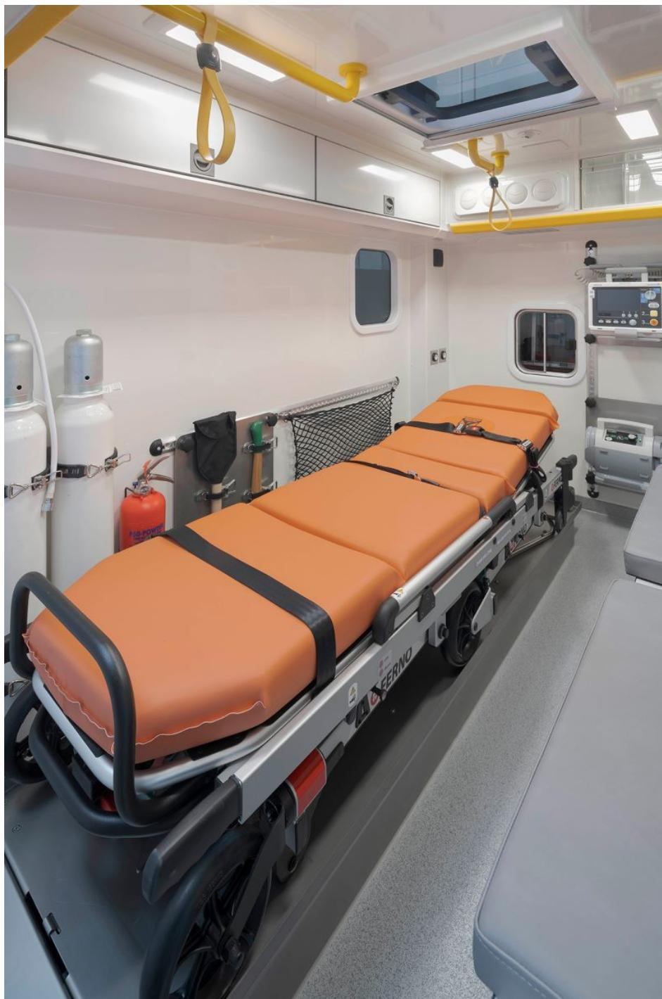
Für den Aufbau wurde ausschließlich hitzebeständiges anorganisches Material verbaut und die integrierte Hochleistungsklimatechnik im Thermo-Kofferaufbau schützt Besatzung und Patienten vor großer Hitze (Bild: WAS).
