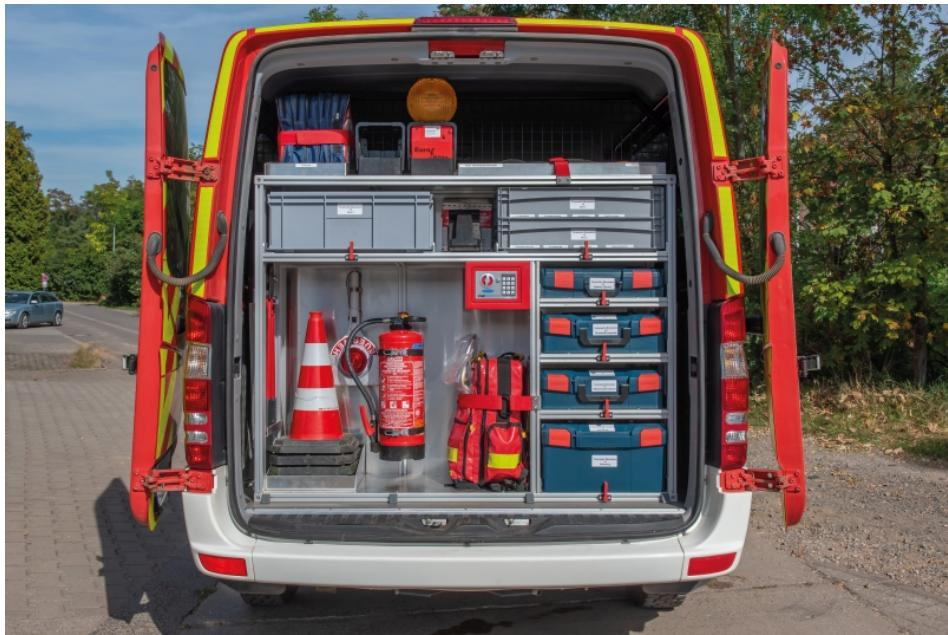
Ein passgenaues Heckregal in einem Kleinfahrzeug – auch in Eigenregie und nachträglich ist dies problemlos möglich (Bild: MiniTec).
