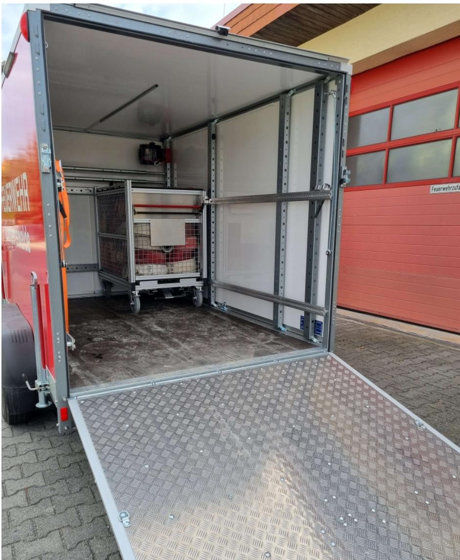
An seitlichen Schienen werden die Rollcontainer zusätzlich befestigt/gesichert. Eine Seilwinde im Inneren ist für besonders schwere Aufgaben vorgesehen (Bild: Stema).
