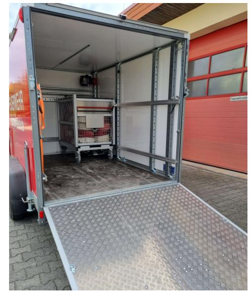
An seitlichen Schienen werden die Rollcontainer zusätzlich befestigt/gesichert. Eine Seilwinde im Inneren ist für besonders schwere Aufgaben vorgesehen (Bild: Stema).
