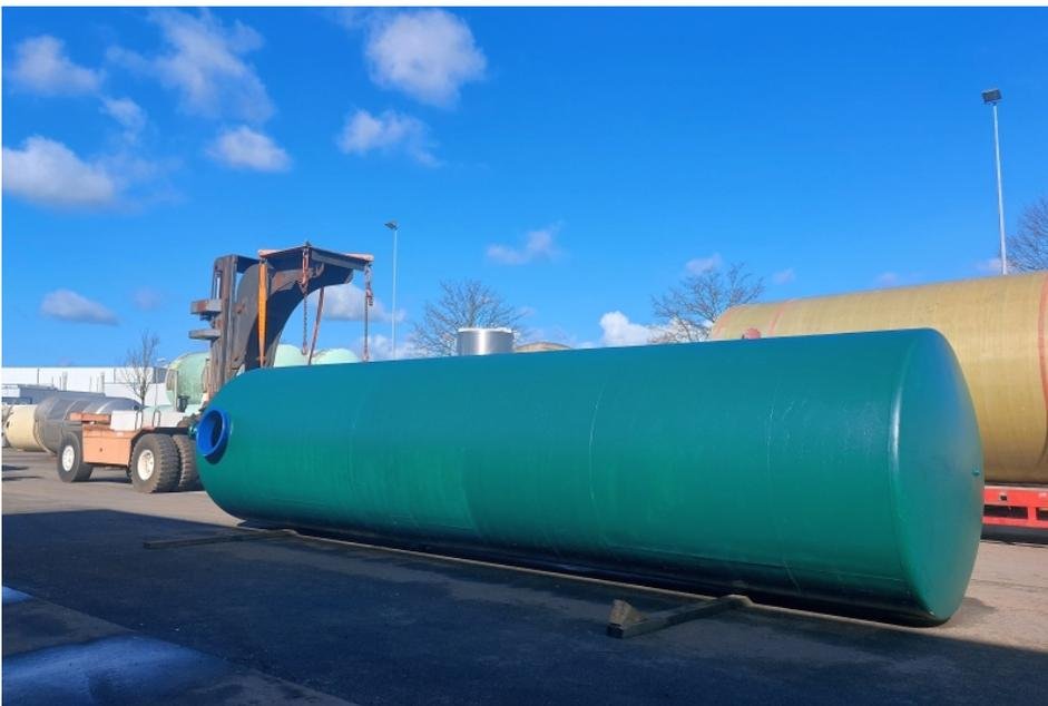
Die Tanks werden mit neuen Feuerwehranschlüssen, Saugleitung, Lüftung und mit neuem Dom und Deckel nach Feuerwehrstandard komplettiert (Bild: Scholten Tanks).
