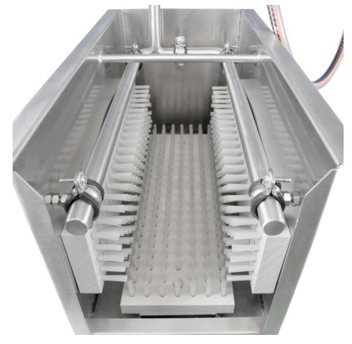
Über die höhenverstellbaren Bürsten sowie Düsenleitungen lassen sich die Stiefelseiten bequem und effektiv reinigen (Bild: 1A Edelstahl).
