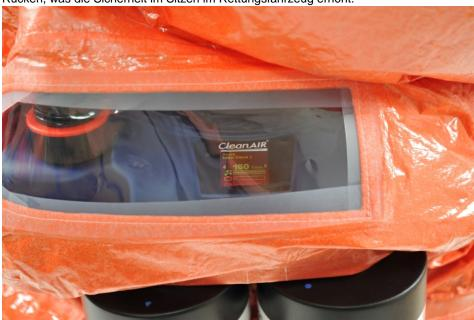
Rückseitiges Sichtfenster für die Warneinrichtungen der unter dem Anzug getragenen »Chemical 2F « / »Chemical 2F EX«-Atemschutzgebläse (Bild: GM).
