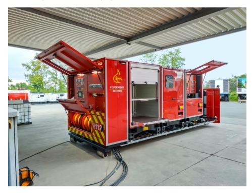
AB-Notstrom 3x 100 kVA = 300 kVA mit Stauraumbox (Bild: Polyma).
