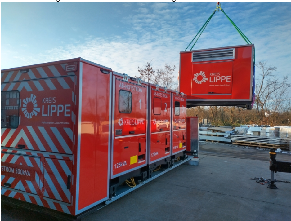
AB-Notstrom 500 kVA mit Kranverladung eines Aggregates (Bild: Polyma).
