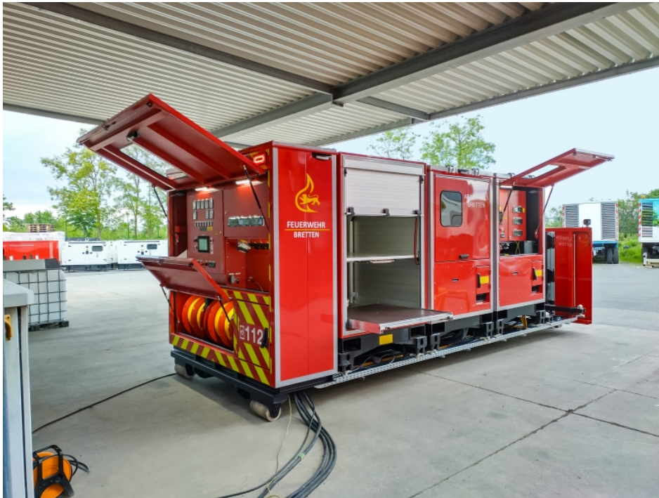
AB-Notstrom 3x 100 kVA = 300 kVA mit Stauraumbox (Bild: Polyma).
