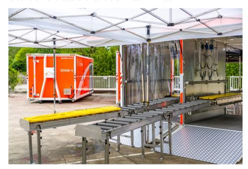
Eine Gemco CBRN-Dekontaminationseinheit ist eine vollständig selbsttragende »Waschanlage« für Personen, die einer chemischen, biologischen, radioaktiven oder nuklearen Belastung ausgesetzt waren (Bild: Gemco).
