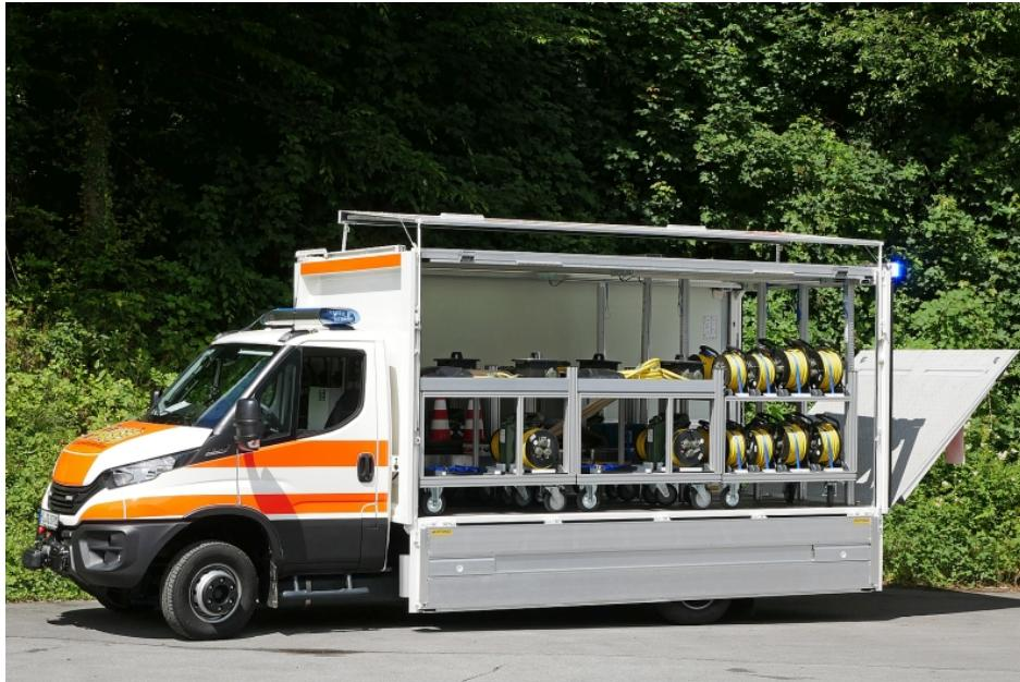
Die Gerätewagen (hier mit Antrieb 4x4) mit Ewers Schwenkwandaufbau für seitliche Gabelstapler-Beladung sind sehr flexibel einsetzbar (Bild: Ewers).
