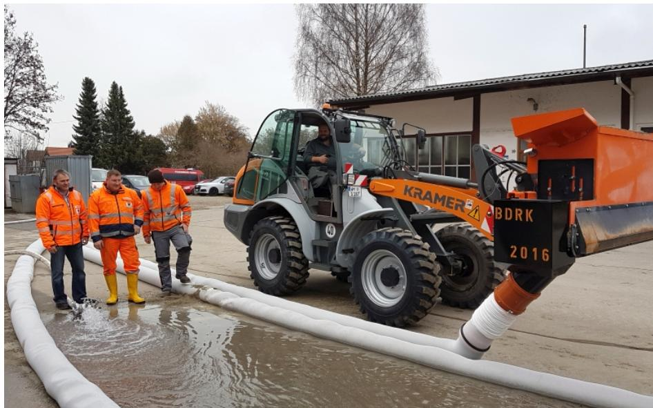
In einer Minute können mit dem »Finliner« bis zu 30 Meter Sandschlauch gefüllt und verlegt werden (Bild: Optimas).
