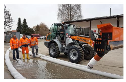
In einer Minute können mit dem »Fineliner« bis zu 30 Meter Sandschlauch gefüllt und verlegt werden (Bild: Optimas).
