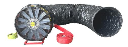
Der »Typhoon Adapter FLY 2025« der Renz GmbH wurde speziell für den Einsatz in explosionsgefährdeten Bereichen sowie schwer zugänglichen Orten wie Tiefgaragen, Kabelschächten oder Tanks entwickelt. Durch die Verbindung mit einem Lüfter – wahlweise mit Elektro- oder Wasserturbinenantrieb – lässt sich Luft gezielt absaugen, wodurch gefährliche Gase sicher entfernt werden.
